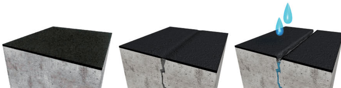
1. Еластична, але не тріщиностійка гідроізоляція не може протистояти постійному тиску води
