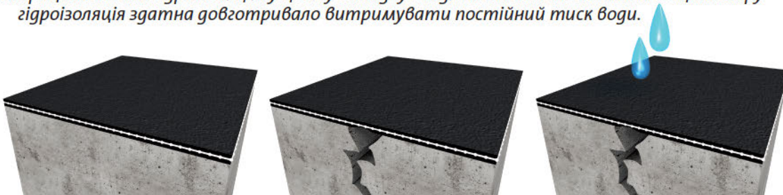
3. Влаштування гідроізоляційного шару, разом з армувальною сіткою: сітка відокремлює верхній шар гідроізоляції від тріщини і в значній мірі допомагає протистояти постійному тиску води.
